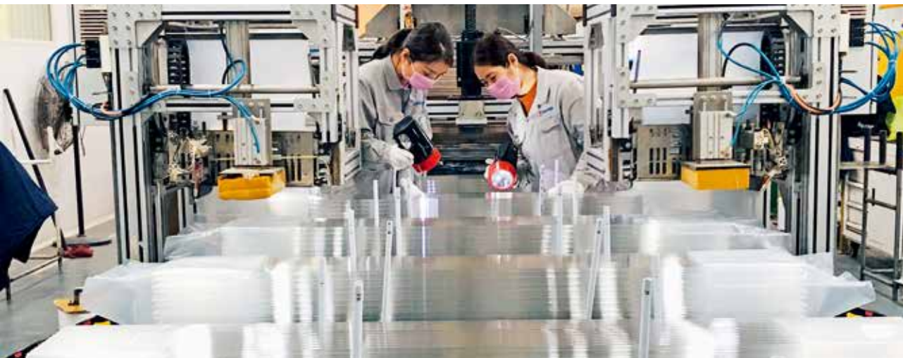
中性硼硅药用玻璃生产线
