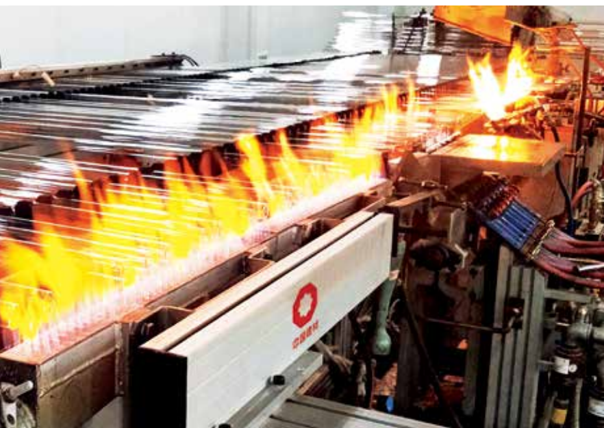
中性硼硅药用玻璃生产线
